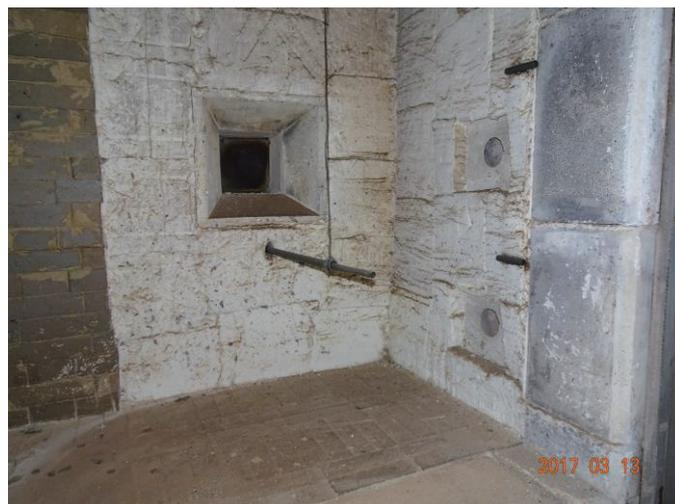
壁用試験炉 W3m × H3m × D1m
