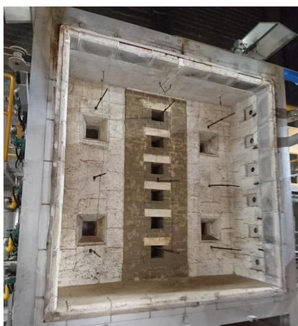
写真 12 壁用試験装置 (星)
