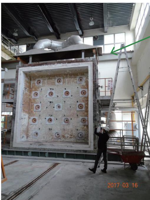
壁用試験炉
